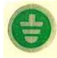
Figure 9 : notification de mise à la terre
